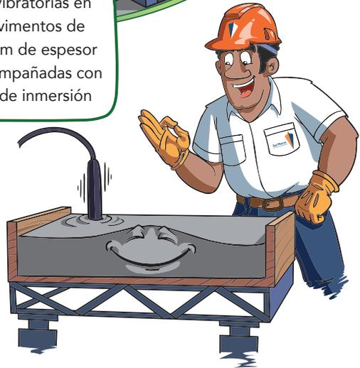
pavimentos, postes, tuberías de gran diámetro y para mezclas secas o semisecas. También forman parte de este grupo los martillos de goma o chapulines, utilizados simultáneamente con los vibradores de inmersión para extraer las burbujas de aire cercanas a la superficie del concreto.
