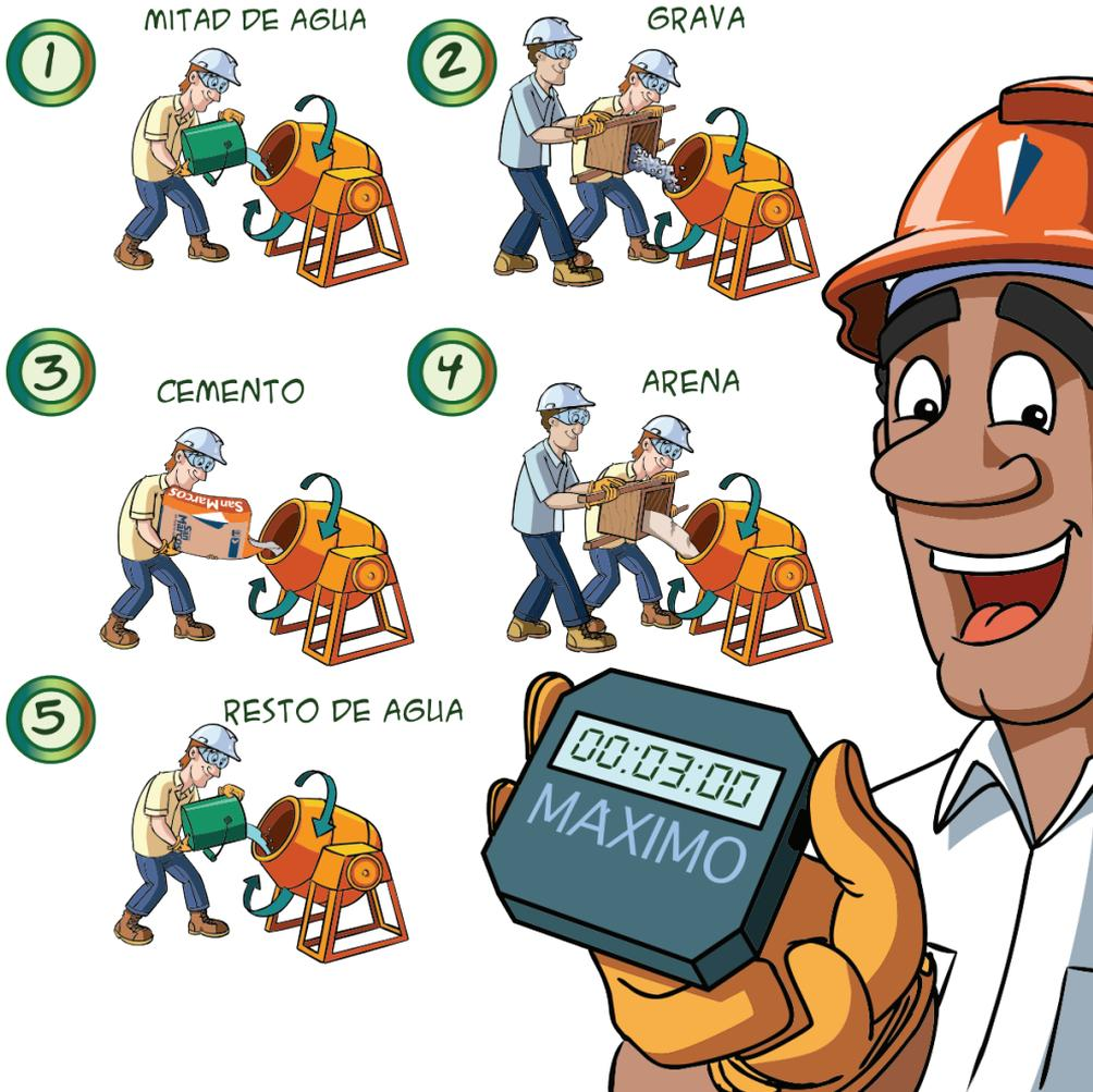
Recordemos que después de introducir la totalidad de los materiales se empieza a contar el tiempo de mezclado, el cual debe ser mínimo de 1,5 minutos y máximo de 3 minutos.
