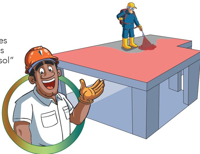
Cuando la superficie se encuentra demasiado blanda para aplicar materiales o agentes de curado, que pueden dañar la superficie, se recomienda utilizar un retardador de evaporación o aplicar el agua en forma de rocío muy fino o de nebulización, con lo que se protegerá la superficie de la pérdida de humedad, hasta que se endurezca lo suficiente para comenzar un curado intensivo.
